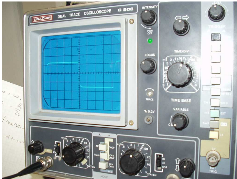
Figura 8: Tensione risultante ai capi del condensatore in condizioni di smorzamento critico.
