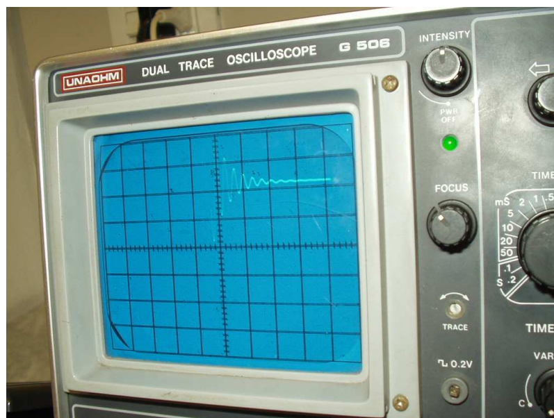
Figura 7: Tensione risultante ai capi del condensatore in condizioni di sottosmorzamento.
