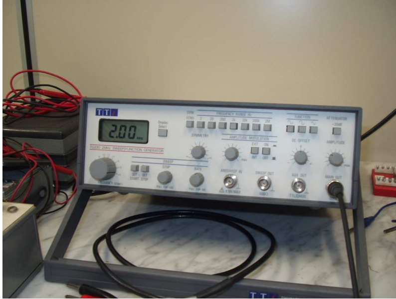
Figura 5: Il generatore di onde impostato per fornire tensioni sinusoidali di ampiezza 5V e frequenza di 2kHz.
