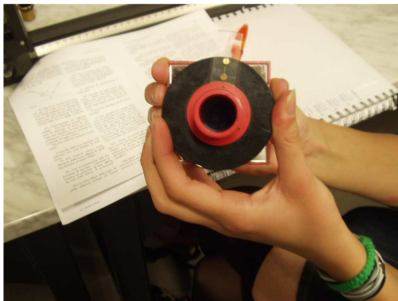
Figura 5: In alto: la luce riflessa dallo specchio dietro al polarizzatore circolare passa indisturbata se viene messo il polarizzatore lineare verso lo specchio. In basso: la luce riflessa dallo specchio dietro al polarizzatore circolare non passa se viene messa la lamina quarto d'onda del polarizzatore dalla parte dello specchio.
