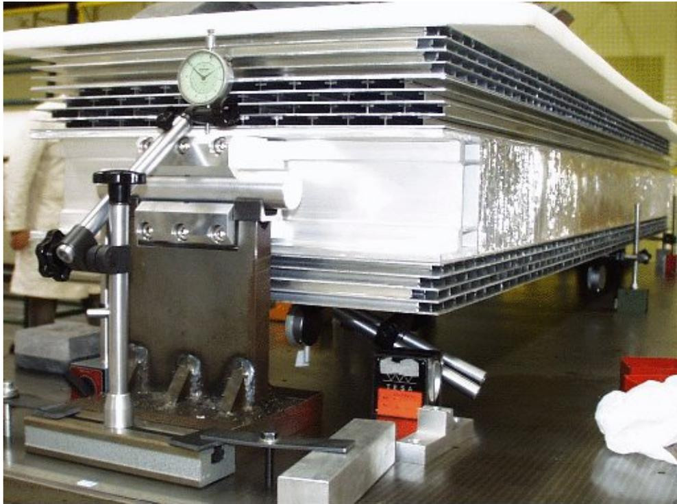
Figura 2.6: Fotografia di una camera a deriva: si distinguono le diverse orientazioni dei DT.
